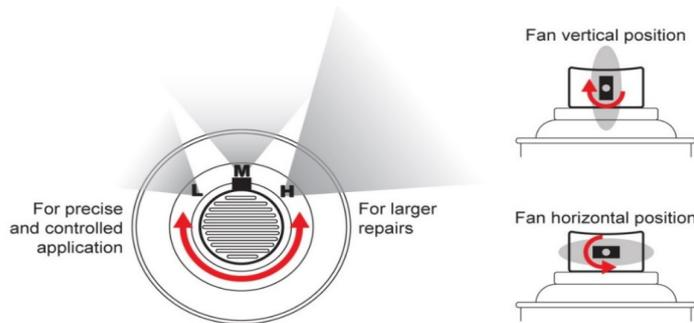
1. Die waagerechte und senkrechte Sprühhichtung der Düse an der Spraydose lässt sich auf die Größe der Ausbesserungsstelle einstellen.
