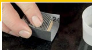
**Schleifen:** Die Schadstelle dann mit Micro-Schleifleinen 2400/ 3200/4000 nass überschleifen (Schleifleinen faltenlos über den Polierblock legen und fixieren). Danach mit einem trockenen Baumwolltuch gut trocknen. **Hinweis:** Nach Gebrauch die Schleifleinen auswaschen und trocknen lassen.
