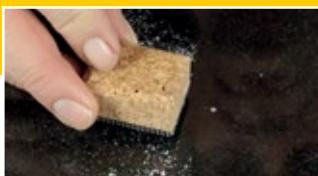
**Plan abtragen:** Überstehendes Material mit dem Lackhobel in kurzen, schnellen Bewegungen abtragen. Den Hobel nach Gebrauch mit einem trockenen Baumwolltuch reinigen.
