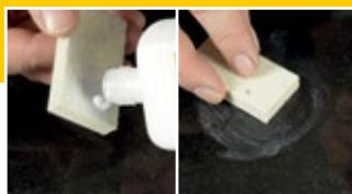
**Polieren:** REPAIRLUX® Polierpaste auf die trockene Oberfläche auftragen und mit dem Filz-Schlefklotz aufpolieren. Sollten Sie den gewünschten Glanzgrad noch nicht erreicht haben, so polieren Sie ein weiteres Mal. (**Hinweis:** Alternativ kann auch mit einer Filzscheibe maschinell gearbeitet werden.) Nach dem Polieren die Oberfläche mit einem trockenen Baumwolltuch trocken reiben.
